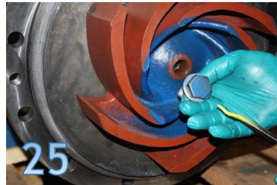
25. Install impeller bolt.
